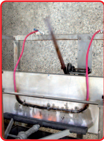
Resistenza al fuoco con shock meccanico e spruzzi d'acqua / Fire resistance with mechanical shock and water spray
