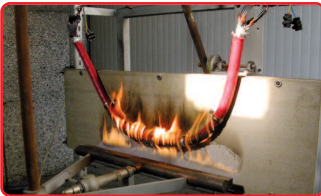
Resistenza al fuoco con shock meccanico / Fire resistance with mechanical shock
