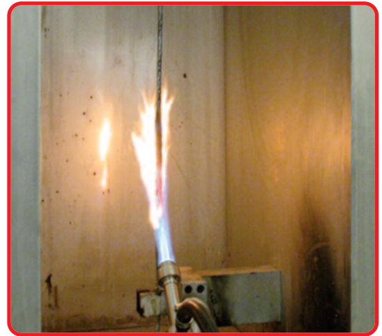
Propagazione della fiamma su cavo singolo / Flame spread of single cable
