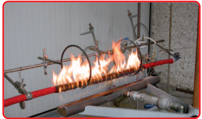
Resistenza al fuoco con sola fiamma / Fire resistance with flame only
