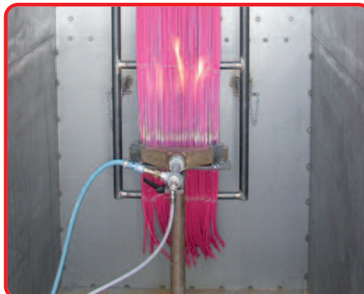
Propagazione dell'incendio su cavi montati a fascio / Flame spread of bunched cables
